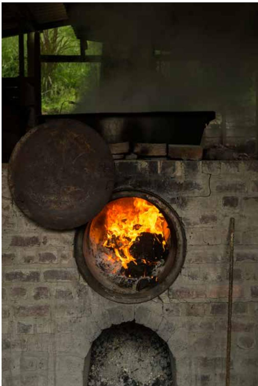
Los hornos de carbón, que se deben mantener prendidos por varios días al mes, calientan el agua salina que se transporta por mangueras desde los pozos. Fotografía de César Romero para el CNMH.
