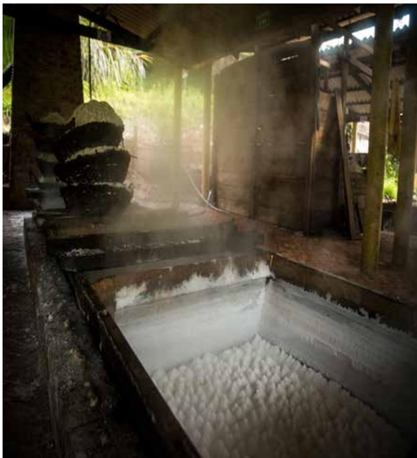
Luego de que el agua se evapora por las altas temperaturas que genera el horno, la sal queda en el asiento de las pailas hasta secarse. Fotografía de César Romero para el CNMH.
